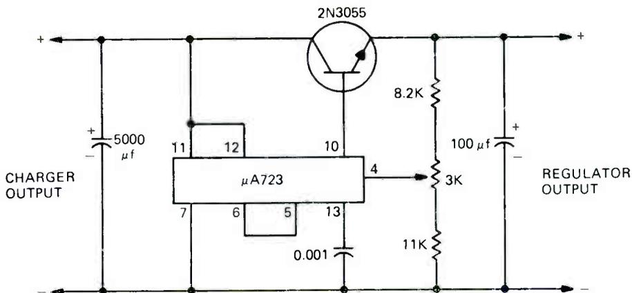
FIGURE 2. REGULATOR HUNG ACROSS CHARGER OUTPUT.
