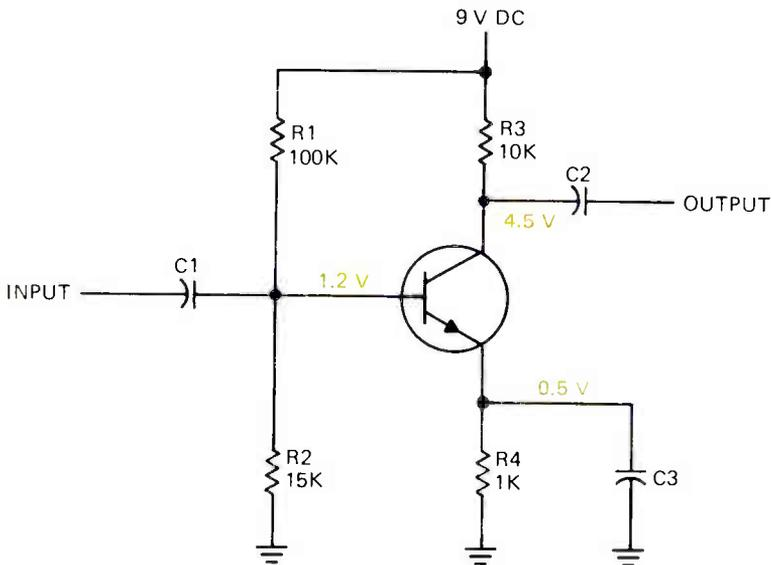
FIGURE 2. A TYPICAL COMMON-EMITTER NPN AMPLIFIER.
