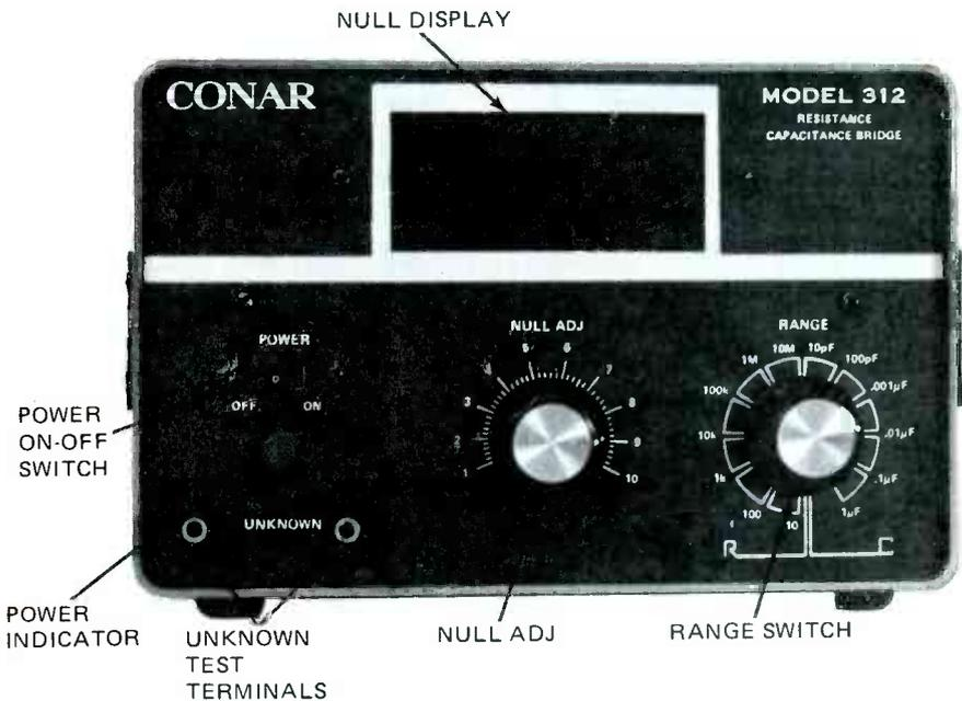
FIGURE 7. LOCATION OF THE OPERATING CONTROLS ON THE FRONT PANEL.
