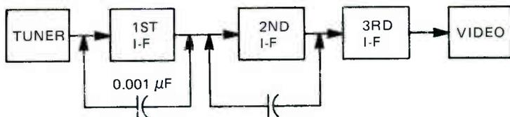
FIGURE 4. JUMPING THE I-F STAGES WITH A CAPACITOR TO FIND THE BAD STAGE.
