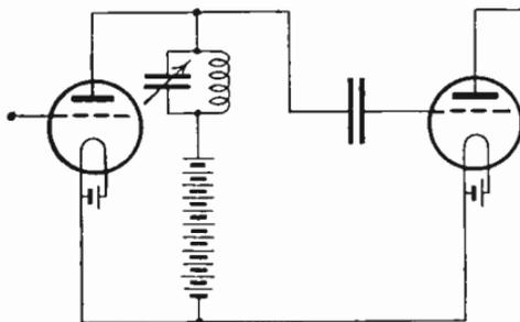
FIG. 3.—TUNED ANODE COUPLING
