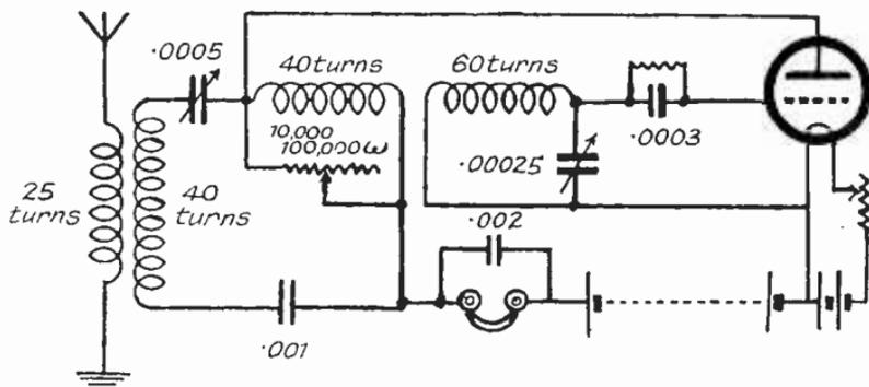
FIG. 2.—THE SUPER-SELECTIVE CIRCUIT
