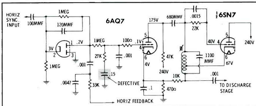
Fig. 1. Gruen horizontal AFC circuit.
