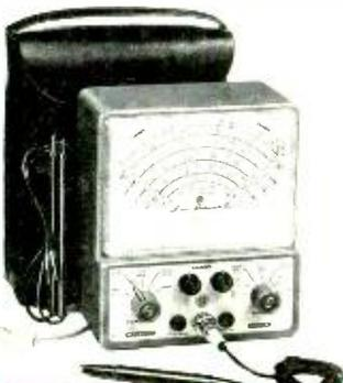
Model 77—Vacuum Tube Voltmeter
