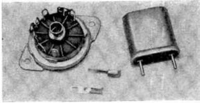
BEFORE MOUNTING TRIMMER CAPACITORS, CUT AWAY SHADED PORTION OF SOLDER TAB
