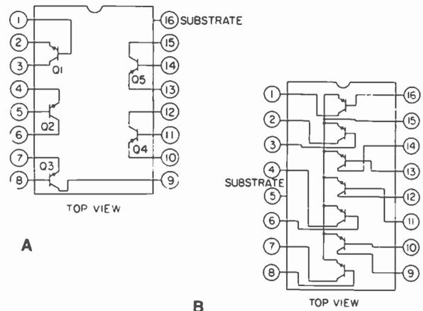
Fig. 2. Transistor arrays: (A) CA3096; (B) CA3081.
