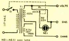
R1—100,000-ohm potentiometer R2—22,000-ohm, 1/2-watt resistor
