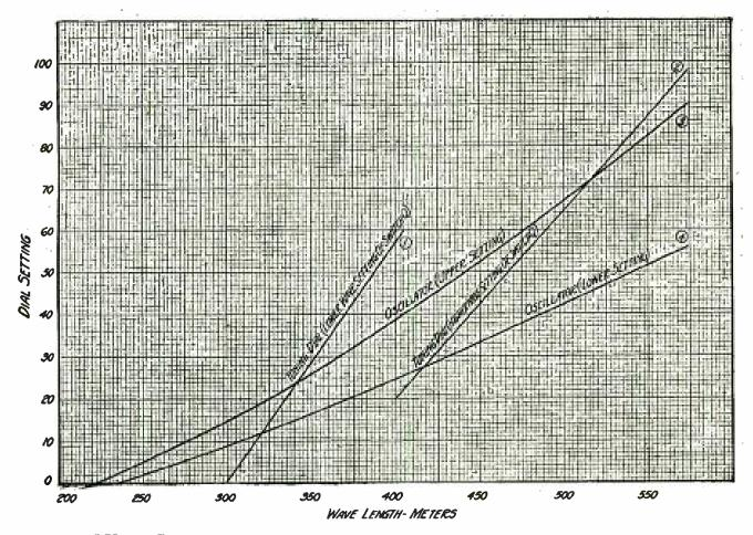
TUNING CHART FOR THE SEVEN-TUBE SUPERHETERODYNE RECEIVER
