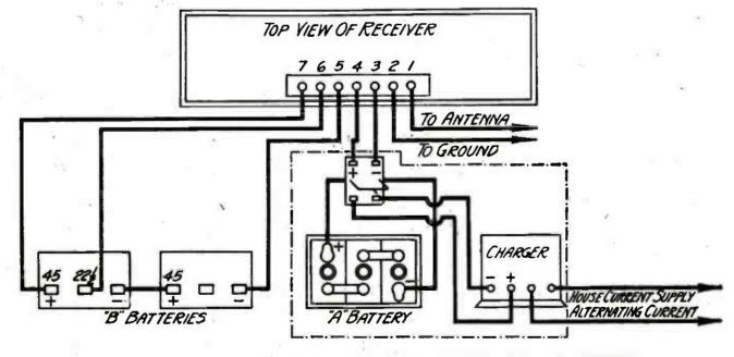
HOW TO CONNECT THE RECEIVER WITH THE BATTERY CHARGER
