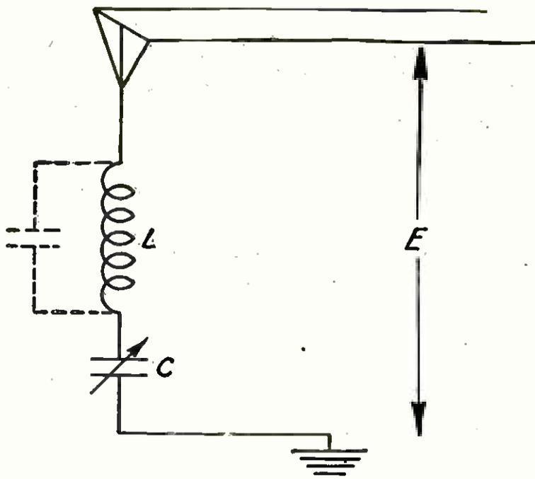
AN ORDINARY TUNED ANTENNA CIRCUIT
