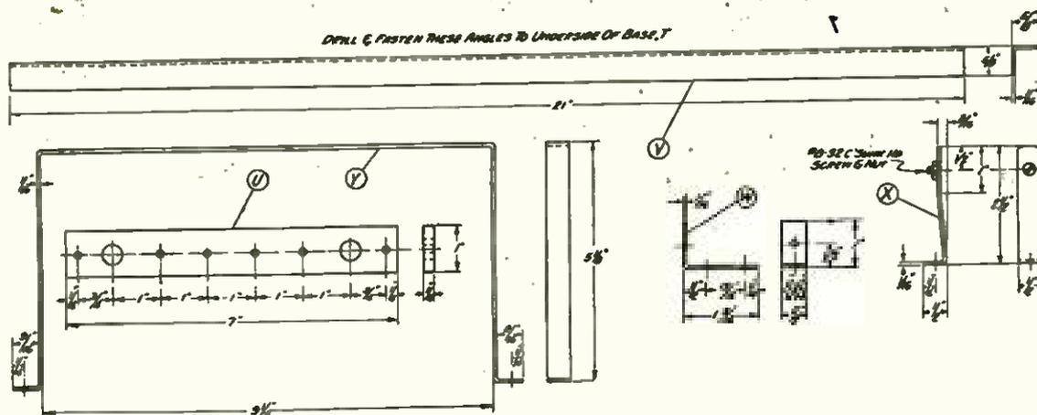
**DETAILS OF THE CONNECTION BLOCK, BRASS STRIPS AND BRACKETS**
