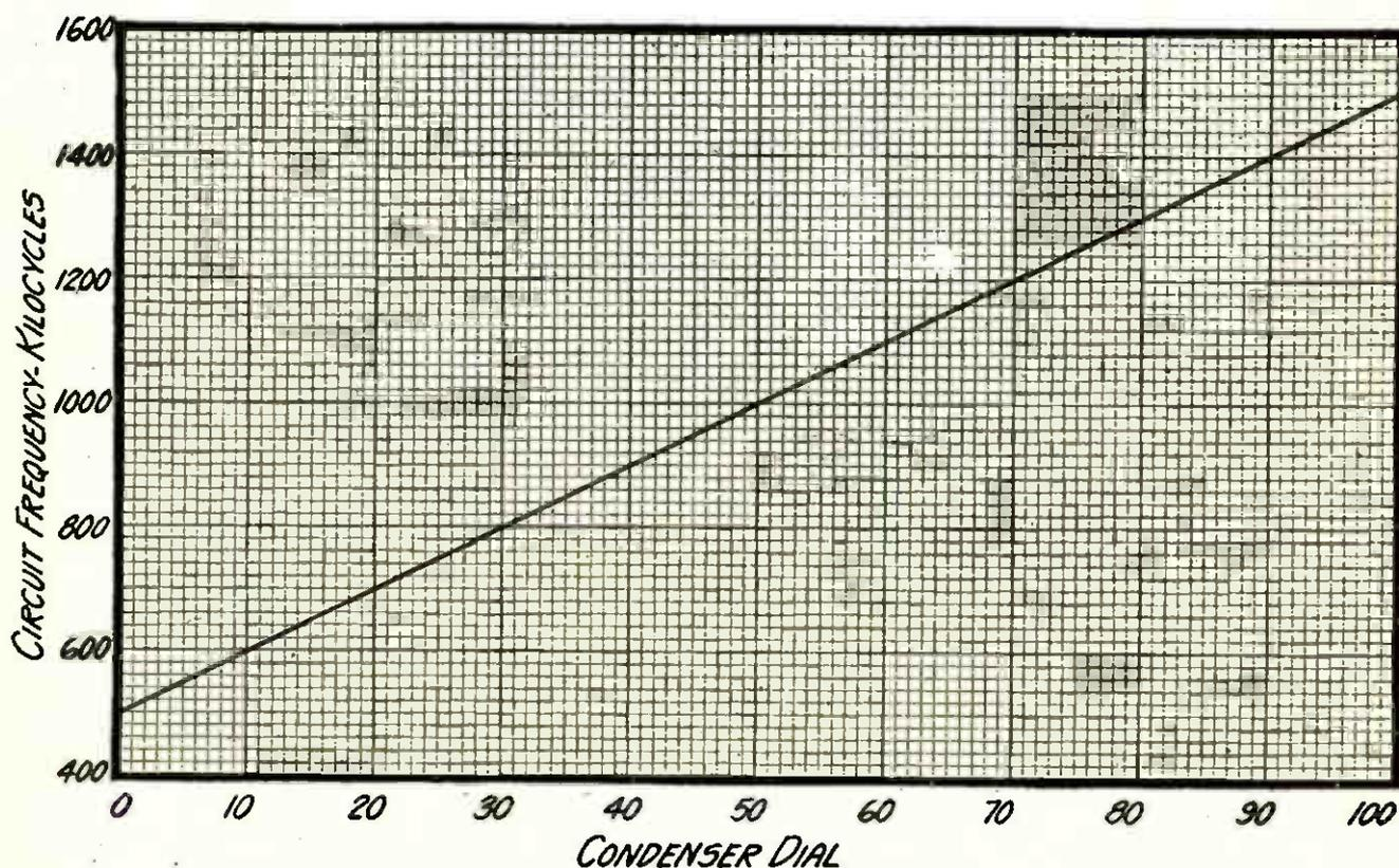
THE STRAIGHT-LINE-FREQUENCY TUNING CURVE
