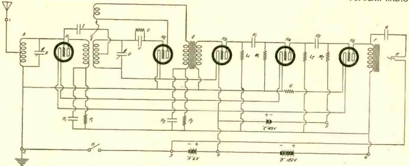
**THE CIRCUIT DIAGRAM FOR THE RECEIVER**
