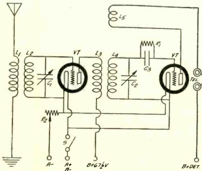
**THE SCHEMATIC CIRCUIT FOR A SIMPLE TWO-TUBE SET**
