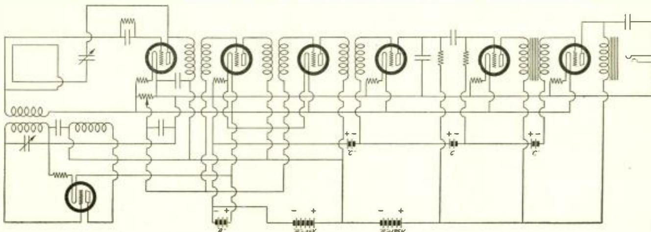
A SENSITIVE SEVEN-TUBE SUPERHETERODYNE CIRCUIT
