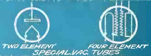
TWO ELEMENT SPECIAL VAC. TUBES FOUR ELEMENT SPECIAL VAC. TUBES
