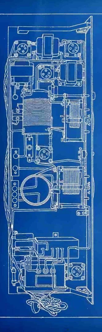
FIG. 2 TOP VIEW BROWNING-DRAKE POWER OPERATED RECEIVER
