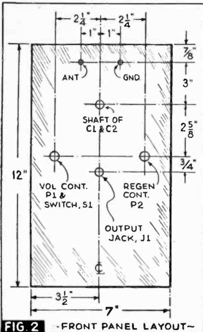
FIG 2 ~ FRONT PANEL LAYOUT ~
