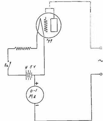
Fig. 3. Output meter circuit.
