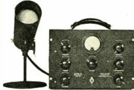
TYPE 130 PORTABLE OSCILLOGRAPH
