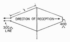
Fig. 11 The V antenna.
