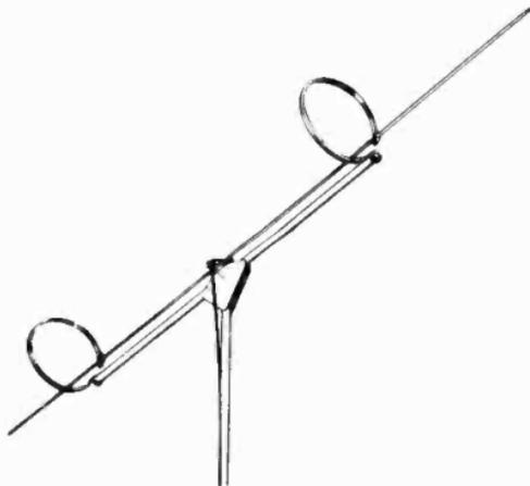
Figure 36. Duo-dipole antenna.
