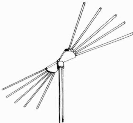
Figure 45. Multi-channel fan antenna.
