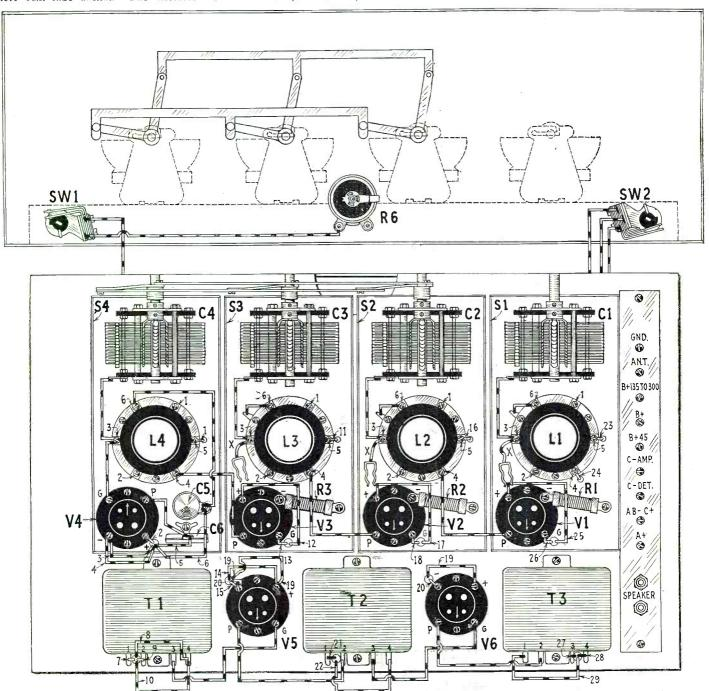
WIRES MARKED X CLIP TO TERMINALSON TOP OF SHIELDED-GRID TUBES
