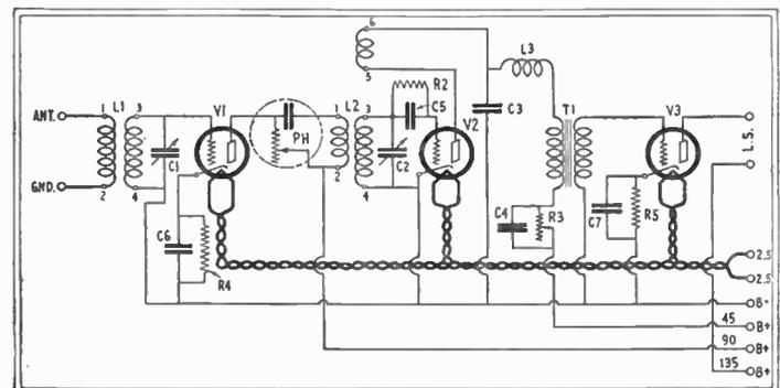
IF IT IS DESIRED TO REWIRE THE BEGINNER'S THREE RECEIVER FOR A.C. OPERATION, THE CIRCUIT SHOWN HERE SHOULD BE EMPLOYED
