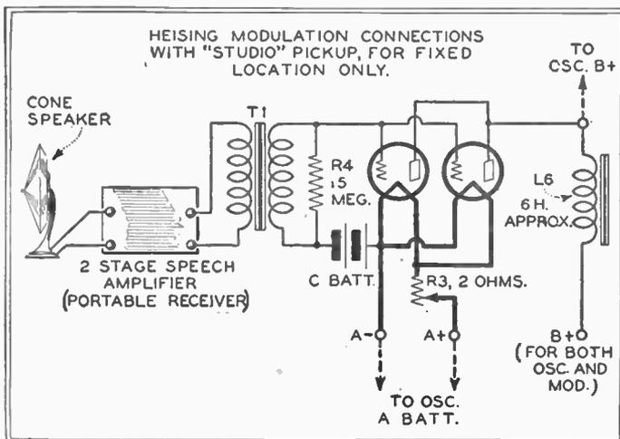
FIG. 4—IN A PERMANENT LOCATION PHONE TRANSMISSION CAN BE IMPROVED BY THE USE OF A VOICE MODULATION SYSTEM WHOSE CIRCUIT IS SHOWN AT THE LEFT
