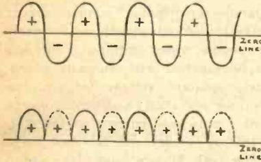
Fig. 2. Half Wave Rectifier
