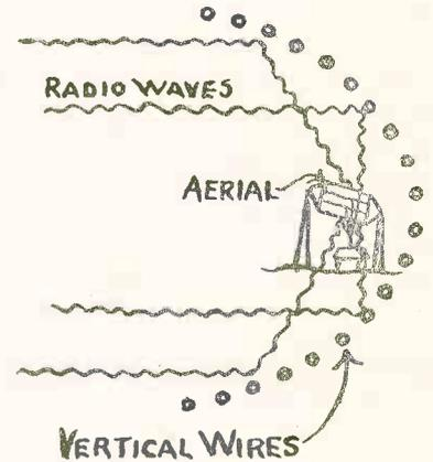
Fig. 3. A Radio Reflector
