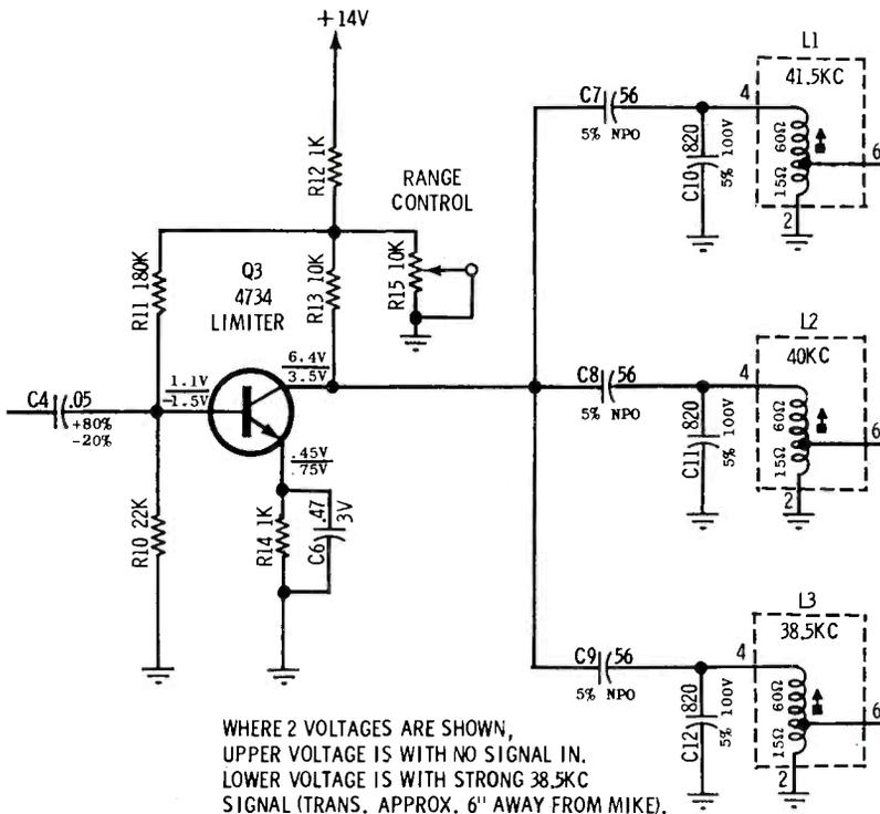
WHERE 2 VOLTAGES ARE SHOWN, UPPER VOLTAGE IS WITH NO SIGNAL IN. LOWER VOLTAGE IS WITH STRONG 38.5KC SIGNAL (TRANS. APPROX. 6' AWAY FROM MIKE).
