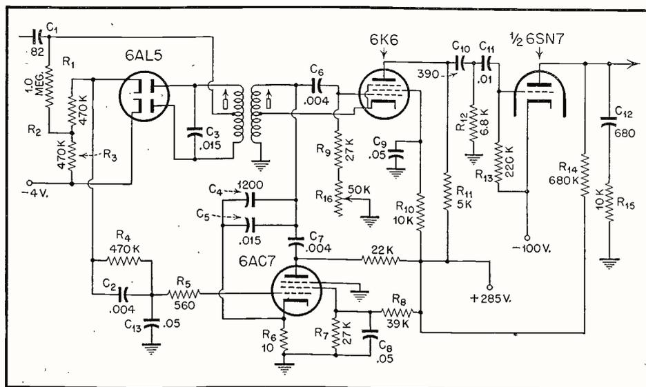
Fig. 3. Synchrolock a-f.c. circuit.
