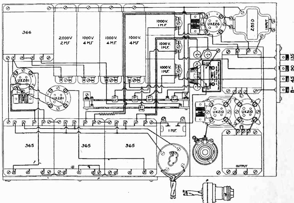
THE PHYSICAL LAYOUT OF THE PUSH-PULL AMPLIFIER AND POWER SUPPLY OF WHICH THE OTHER DIAGRAM SHOWS THE ELECTRICAL ARRANGEMENT. COMPACTNESS IS AN OUTSTANDING FEATURE.
