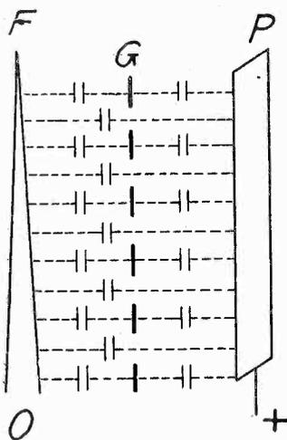
**FIG. 5—THE INTER-ELECTRODE CAPACITIES IN AN ORDINARY TRIODE GIVE RISE TO DETRIMENTAL EFFECTS, NOTABLY OSCILLATION BY FEED BACK THROUGH THE PLATE-GRID CAPACITY.**
