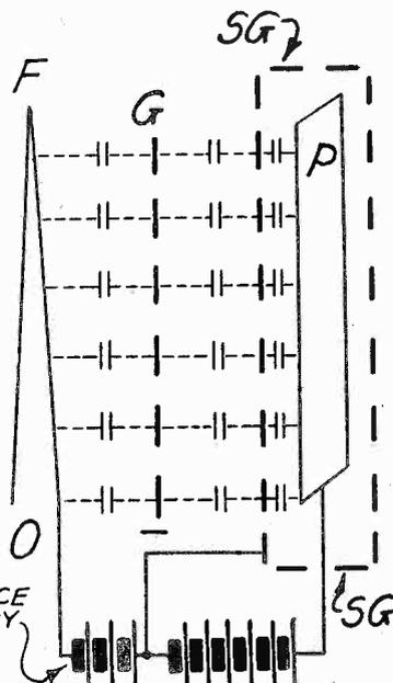
**FIG. 6—IN THE SHIELD GRID TUBE THE CAPACITY BETWEEN THE CONTROL GRID G AND THE PLATE P IS ELIMINATED BY THE INTERPOSITION OF A GROUNDED SHIELD GRID SG. IT IS GROUNDED TO VARIATIONS IN POTENTIALS BUT IS POSITIVE TO STEADY POTENTIALS.**
