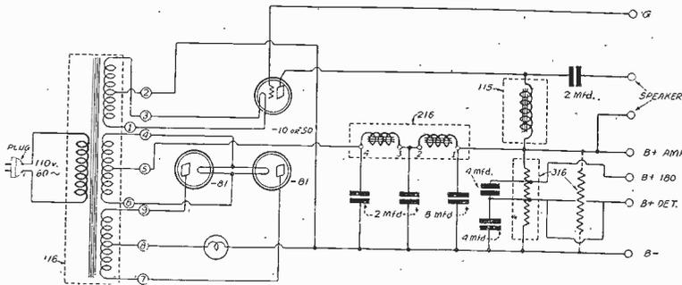
THE CIRCUIT DIAGRAM OF THE VICTOREEN POWER SUPPLY
