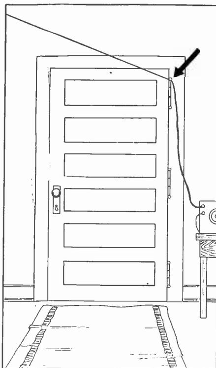
AT LEFT IS SHOWN A COMBINATION OF ELECTRICAL CIRCUMSTANCES FULL OF POTENTIAL NOISE IN THE RECEIVER INSIDE. AT RIGHT IS SHOWN A CARELESS RADIO INSTALLATION WHICH MIGHT RESULT IN NOISY RECEPTION.
