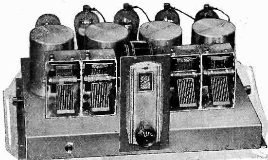
EACH STAGE OF THE MB-29 IS SEPARATELY SHIELDED. THE CYLINDRICAL CONTAINERS ARE THE SHIELDS. THEY ARE ALUMINUM. INSIDE EACH SHIELD ARE THE FILTERS FOR EACH STAGE. NOTE THE NEW NATIONAL MODERNISTIC DIAL IN THE ILLUSTRATION AT LEFT. THE REAR VIEW OF THE MB-29 IS SHOWN AT RIGHT.
