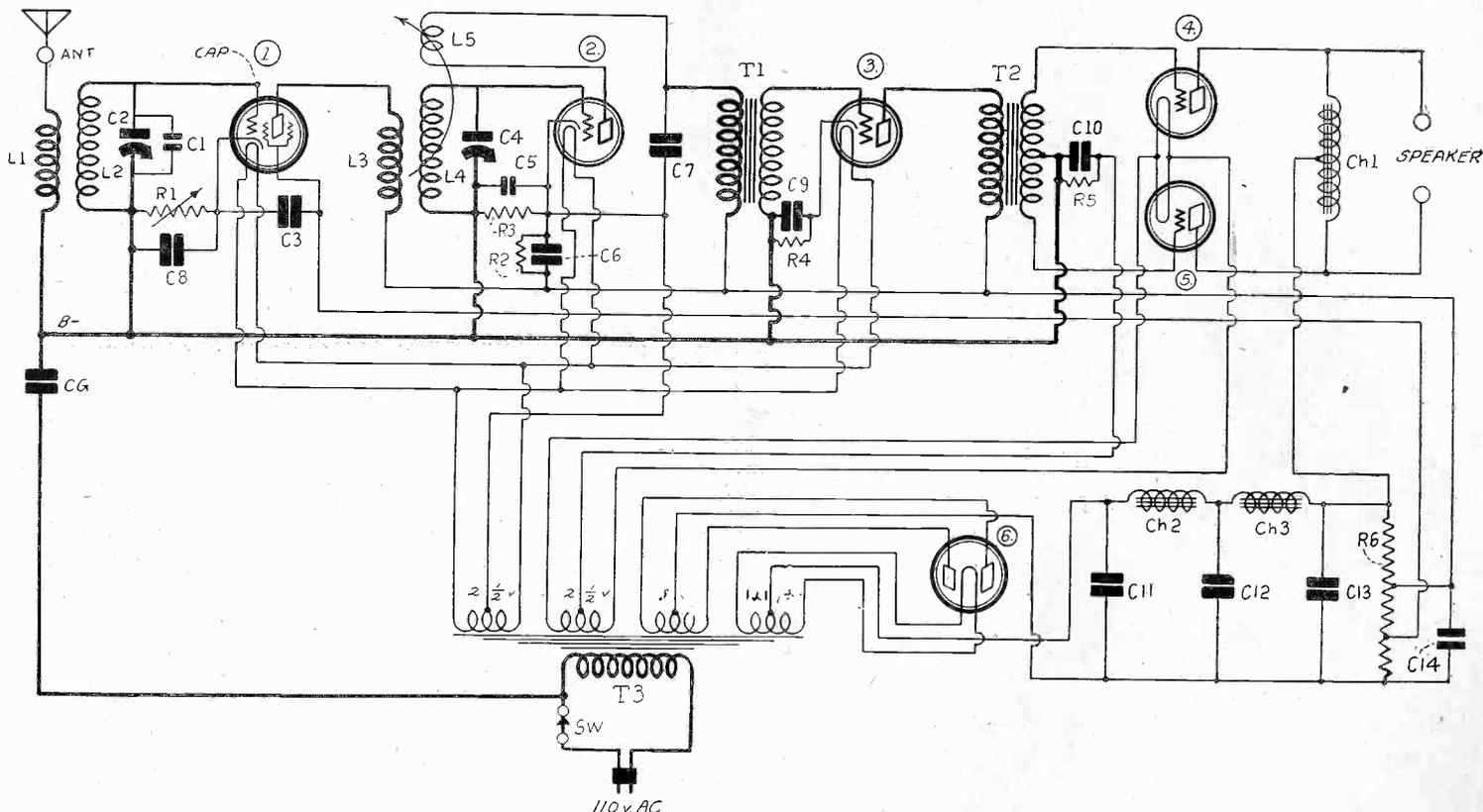
**TWO 245 TUBES IN PUSH-PULL CONSTITUTE THE OUTPUT OF THE 5-TUBE AC DIAMOND OF THE AIR.**
