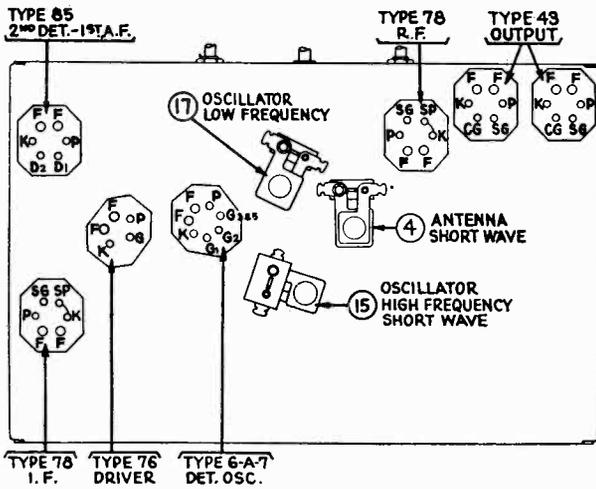
Fig. 1—Tube Sockets
