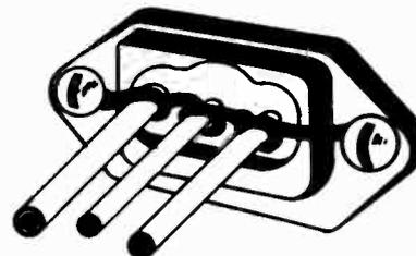
FIGURE 4. DISTRIBUTOR RESISTOR
