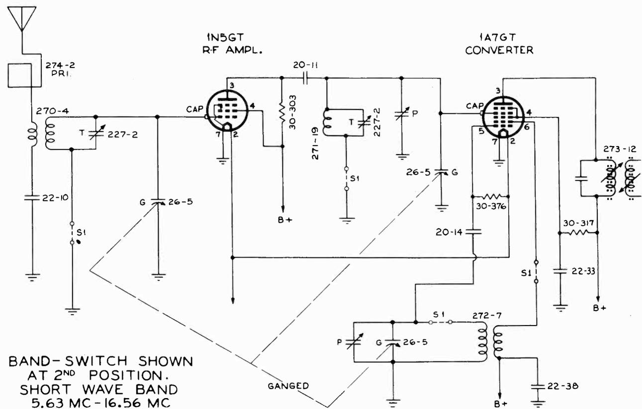
BAND-SWITCH SHOWN AT 2<sup>ND</sup> POSITION. SHORT WAVE BAND 5.63 MC - 16.56 MC
