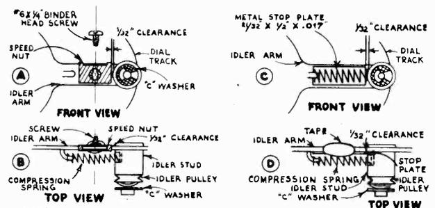
MS 728 ALL PULLEYS MUST BE ON TRACK
