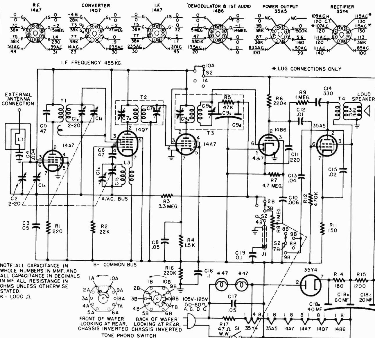
FIG. 4 - SCHEMATIC DIAGRAM - MODEL 65P4
