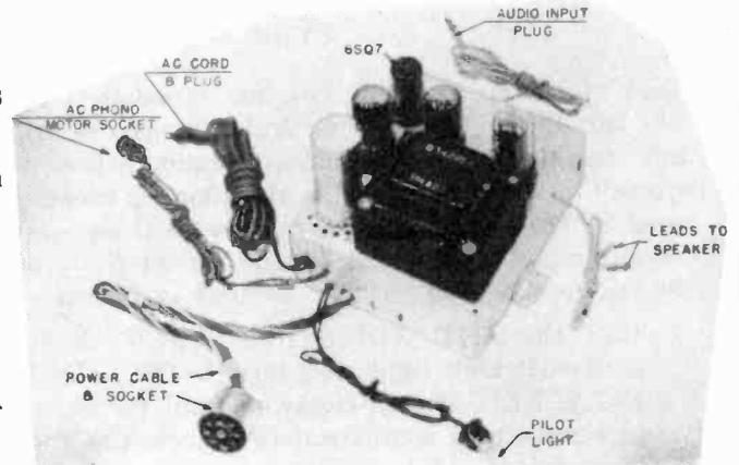
POWER SUPPLY & POWER AMPLIFIER CHASSIS.
