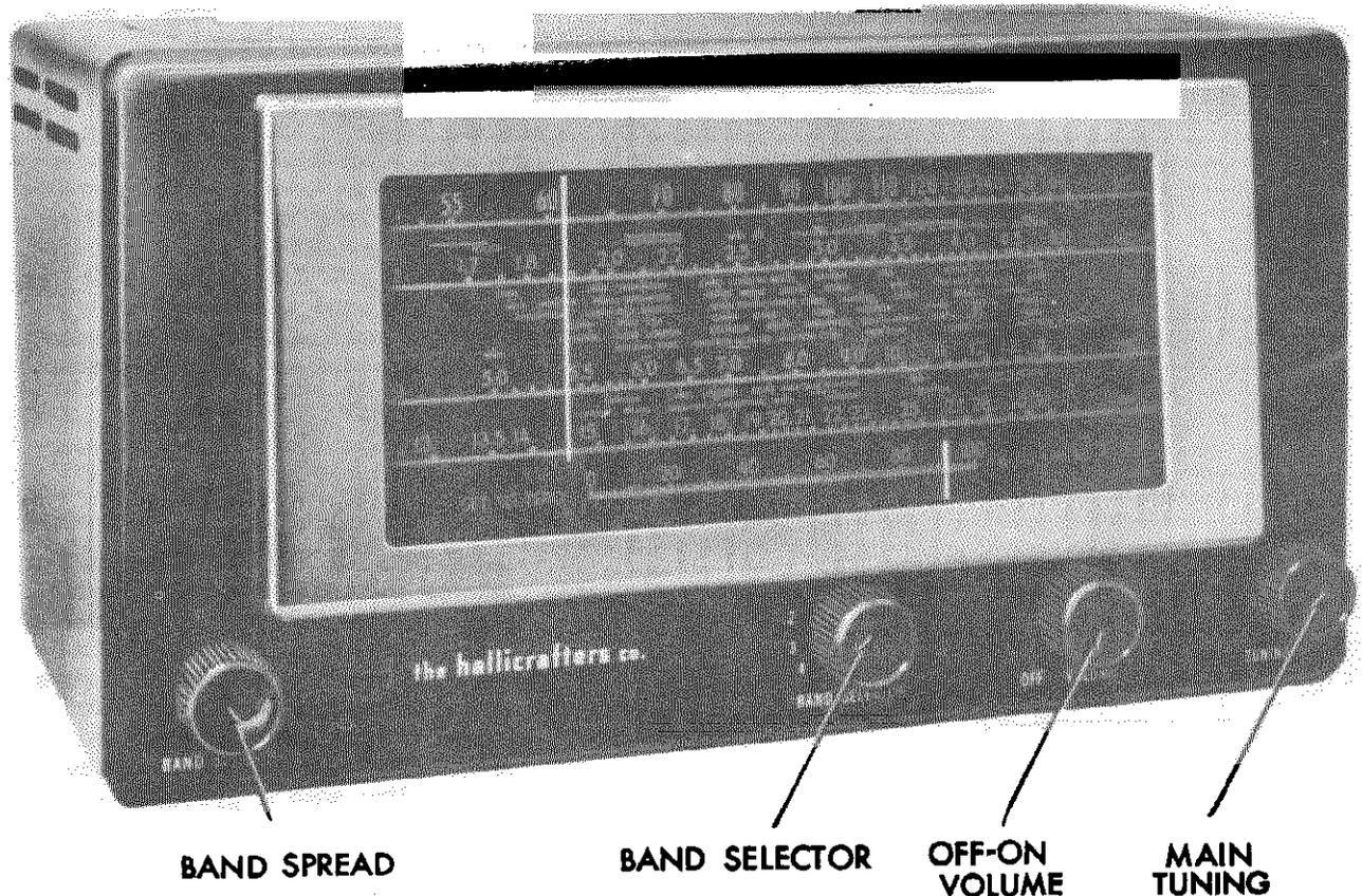
FIG. 1. RADIO RECEIVER MODEL 5R10
