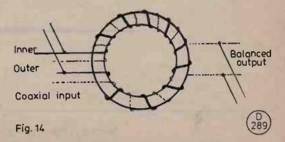
Fig. 14. Broadband toroidal balun.
