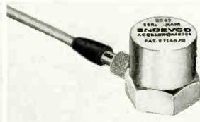
**HIGH TEMPERATURE ACCELEROMETER**
