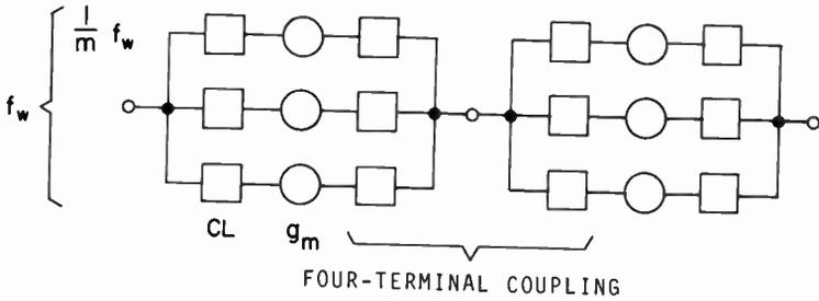
$$mn \text{ TUBES} = m \text{ PER STAGE} \times n \text{ STAGES}$$
