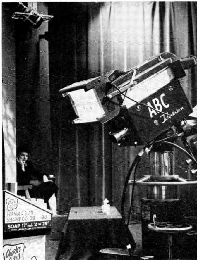
Fig. 22-5. TelePrompter in action on a live commercial.
