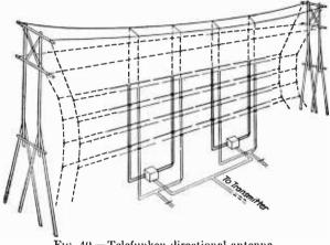
Fig. 40.- Telefunken directional antenna.
