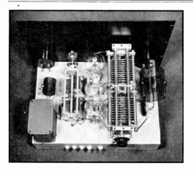
Figure 32. THE PUSH-PULL 75T FINAL AMPLIFIER DECK.
