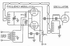
Figure 10. STABILIZED REACTANCE-TUBE MODULATOR.
