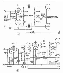
Figure 27. RECOMMENDED PHASE-INVERTER CIRCUITS.
