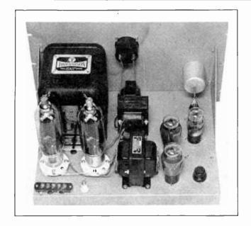
Figure 21. 203-Z SPEECH-MODU-LATOR FOR INPUTS TO 800 WATTS.
