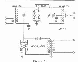
SIMPLE GRID-LEAK MODULATION.
