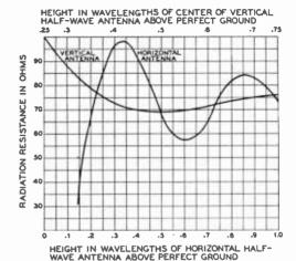
EFFECT OF HEIGHT ON THE RADIATION RESISTANCE OF A DIPOLE SUSPENDED ABOVE PERFECT GROUND.
