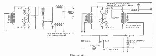
GRID-CONTROLLED RECTIFIER KEYING SYSTEMS.
