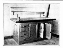
Figure 7. ENCLOSED-TYPE WORKBENCH.
