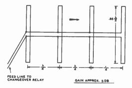
Figure 12. SIMPLE END-FIRE ANTENNA ARRAY.
