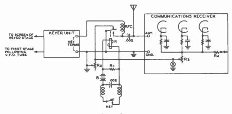
Figure 9. SCHEMATIC OF BREAK-IN SYSTEM.
