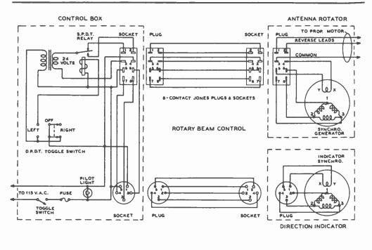
Figure 35. SCHEMATIC OF THE COMPLETE ANTENNA CONTROL SYSTEM.
