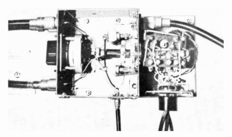
Figure 16. SHOWING THE BC-375 CONTROL RELAY AND ANTENNA SELECTOR.
