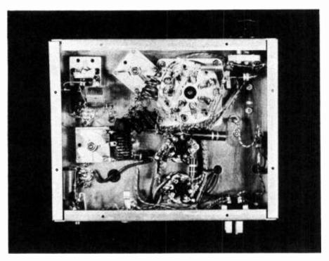
Figure 24. UNDERCHASSIS OF THE 832A 144-MC. TRANSMITTER.
