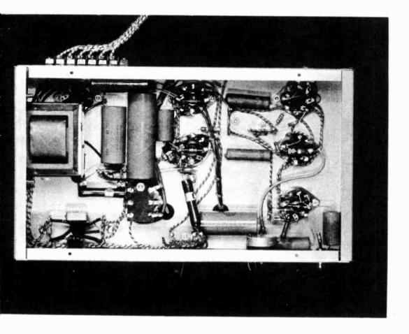
Figure 3. UNDERCHASSIS OF THE 6V6-GT MODULATOR.
