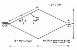
Figure 32. RHOMBIC ANTENNA.
