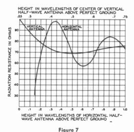
EFFECT OF HEIGHT ON THE RADIATION RE-SISTANCE OF A DIPOLE SUSPENDED ABOVE PERFECT GROUND
