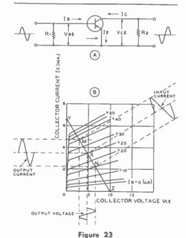
CHARACTERISTIC CURVES AND LOAD LINE FOR COMMON-EMITTER CIRCUIT
