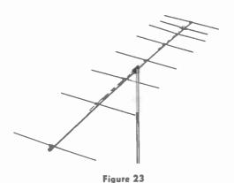
TWO-METER LONG YAGI ARRAY
