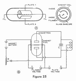
SIMPLE MAGNETRON OSCILLATOR
