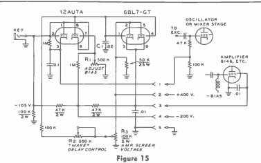
DIFFERENTIAL KEYING SYSTEM FOR SCREEN CIRCUIT
