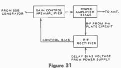
**BLOCK DIAGRAM OF AUTOMATIC** LOAD CONTROL (A.L.C.) SYSTEM
