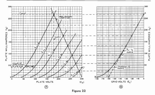
DETERMINATION OF OPERATING PARAMETERS FOR PUSH-PULL CLASS-A
