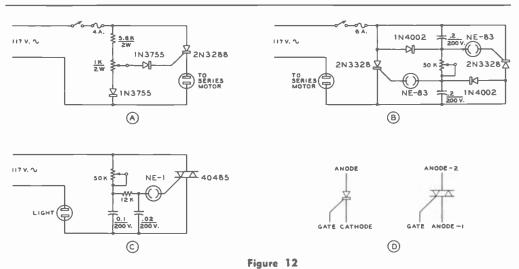
SCR CIRCUITS FOR MOTOR OR LIGHT CONTROL
