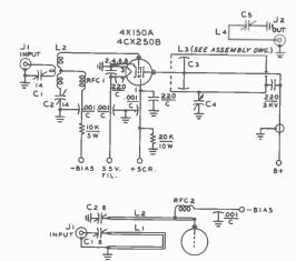
ALTERNATIVE GRID CIRCUIT FOR 432 MHZ AMPLIFIER
