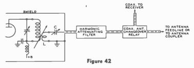
TUNED-LINK OUTPUT CIRCUIT
