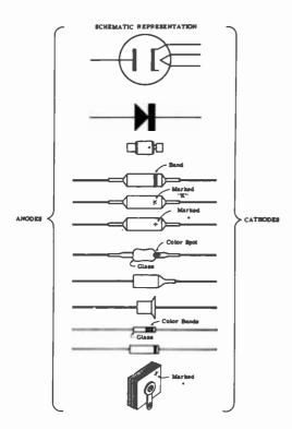
TUBE, GERMANIUM, SILICON AND SELENIUM DIODES
