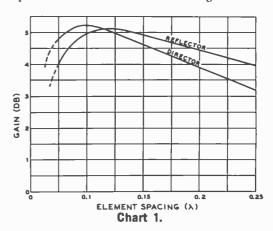
GAIN VERSUS ELEMENT SPACING FOR A TWO-ELEMENT CLOSE-SPACED PARA-SITIC BEAM ANTENNA WITH PARASITIC ELEMENT OPERATING AS A DIRECTOR OR REFLECTOR
