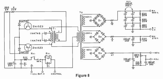
270-WATT MOBILE TRANSCEIVER POWER SUPPLY
