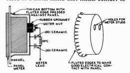
Figure 22 SIMPLE METER SHIELD
