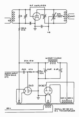
Figure 4 **GRID-BIAS MODULATOR CIRCUIT**
