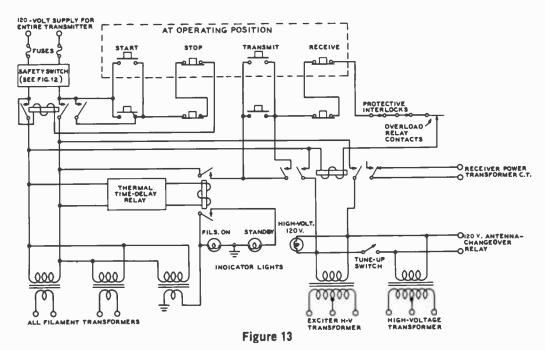
**PUSH-BUTTON TRANSMITTER-CONTROL CIRCUIT**
