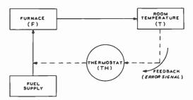
Figure 20 SIMPLE CLOSED-LOOP FEEDBACK SYSTEM
