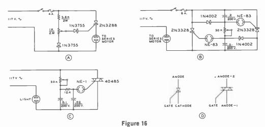
SCR CIRCUITS FOR MOTOR OR LIGHT CONTROL
