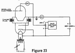
**REFLEX KLYSTRON OSCILLATOR**
