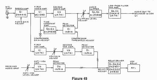
**BLOCK DIAGRAM OF AUDIO AND VOX CIRCUITS**
