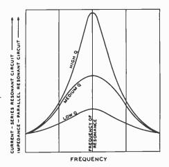
Figure 20 **RESONANCE CURVE**
