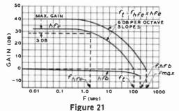
GAIN-BANDWIDTH CHART FOR TYPICAL HF TRANSISTOR
