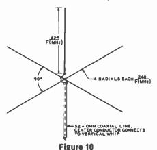
THE HIGH FREQUENCY GROUND-PLANE ANTENNA
