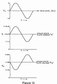
POLARITY REVERSAL BETWEEN GRID AND PLATE VOLTAGES
