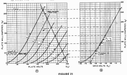
DETERMINATION OF OPERATING PARAMETERS FOR PUSH-PULL CLASS-A TRIODE TUBES
