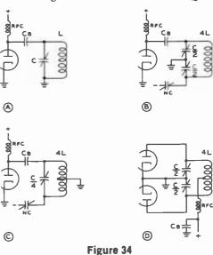
PARALLEL-TUNED TANK CIRCUITS
