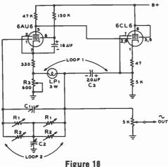
THE NBS BRIDGE-T OSCILLATOR CIRCUIT EMPLOYS TWO FEEDBACK LOOPS. LOOP 1 IS REGENERATIVE, LOOP 2 IS DEGENERATIVE
