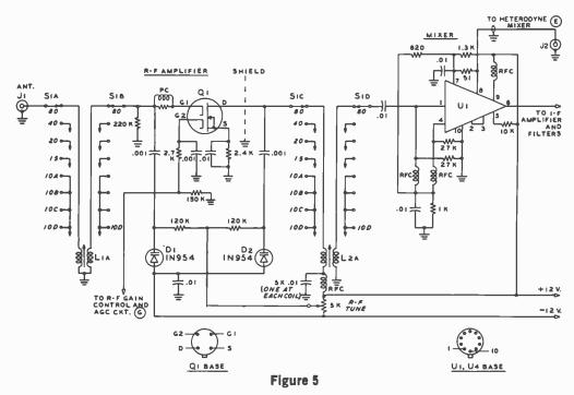
SCHEMATIC, FRONT-END BANDSWITCHING MODULE
