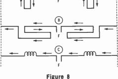
THE LOADED HALF-WAVE ELEMENT
