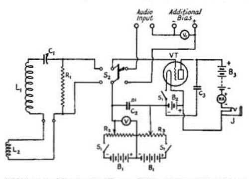
SCHEMATIC CIRCUIT OF THE MODULOMETER
