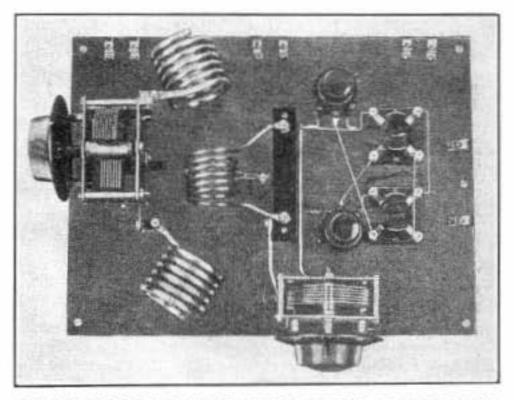
PLAN VIEW OF THE LOW-POWER PUSH-PULL AMPLIFIER
