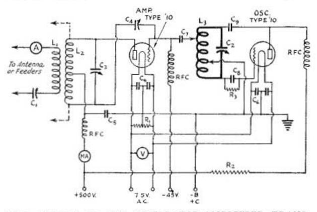
THE CIRCUIT OF THE OSCILLATOR-AMPLIFIER TRANS-MITTER
