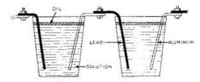
TYPICAL CHEMICAL RECTIFIER CELLS
