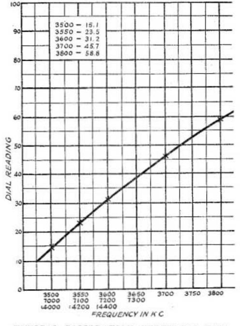
TYPICAL CALIBRATION CURVE FOR THE FREQUENCY METER
