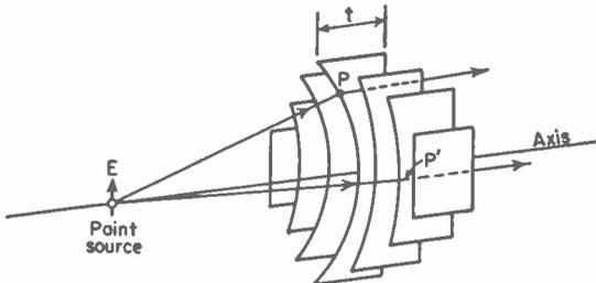
FIG. 14-11.  $E$ -plane type of metal-plate lens.
