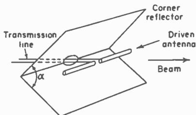
FIG. 12-6. Corner-reflector antenna.
