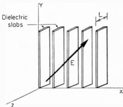
FIG. 14-40. Wave polarizer.
