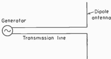
FIG. 1-2. Dipole antenna.
