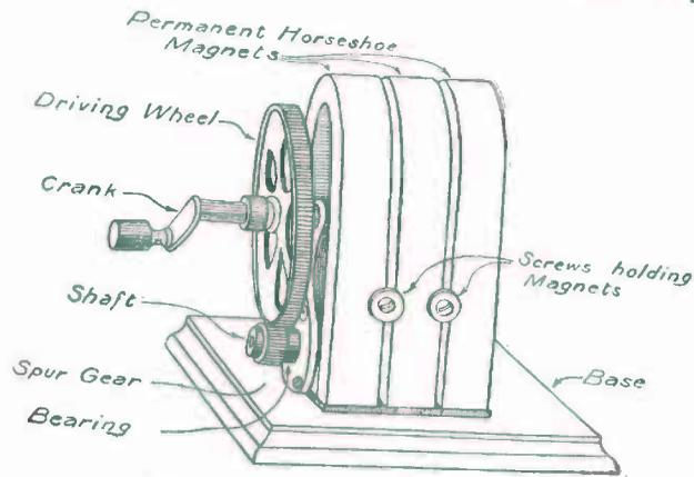
FIG. 251. — A Telephone Magneto.
