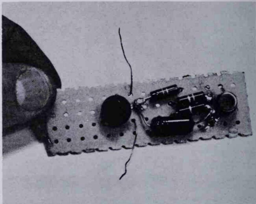
Fig. 10-4. The transistor subchassis.
