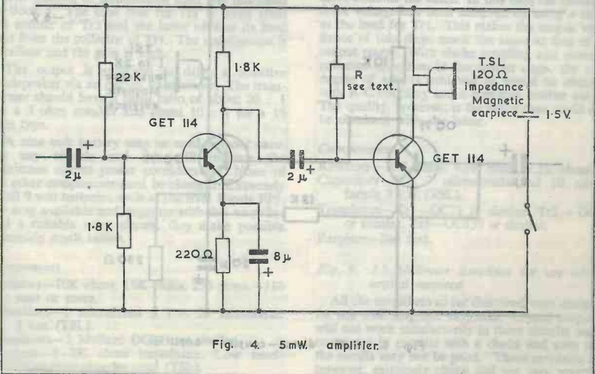
Fig. 4. 5 mW. amplifier.
