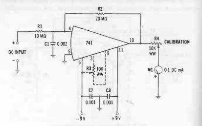
Fig. 3-25. Electronic de voltmeter.
