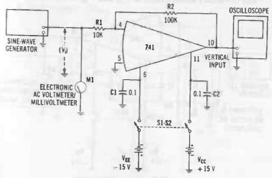
Fig. 2-21. Ac input-voltage range.
