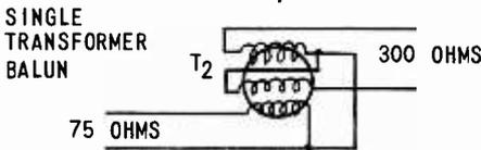
$T_2$  = TOROID, TRIFILAR
